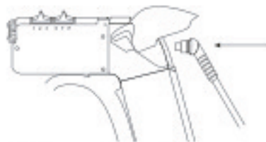
Stecker vorsichtig einführen - der rote Punkt zeigt nach oben
